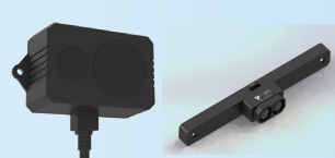
激光&单目视觉冗余备份(引导降落)
